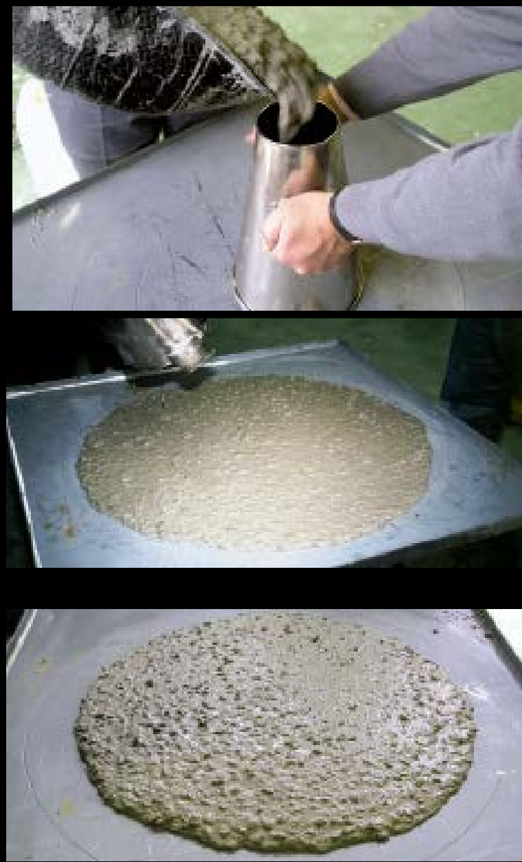
Figura 5.- Ensayo de extensión de flujo.
