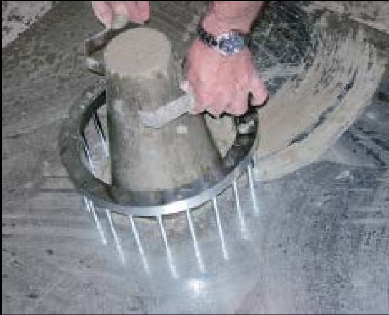
Figura 8.- Ensayo del anillo japonés.
