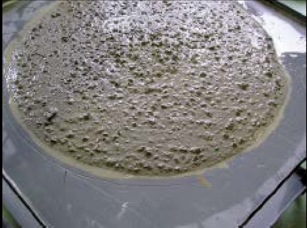
Figura 10.- Ensayo de índice visual de estabilidad (valor índice = 1'5).
