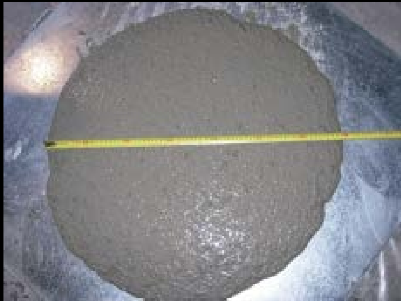
Figura 9.- Ensayo del índice visual de estabilidad (valor índice =0)
