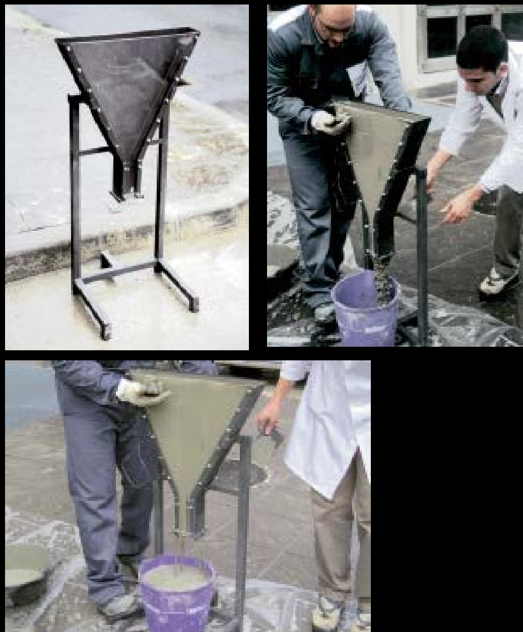
Figura 6.- Ensayo del embudo en V.
