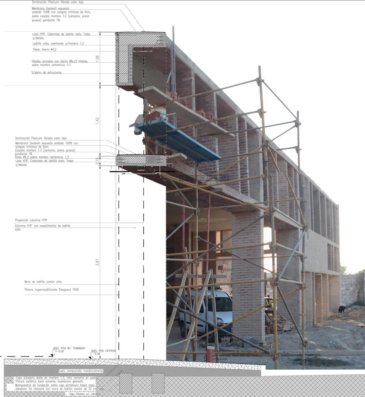
DETALLE CORTE FACHADA 5 (sector ingreso ambulancia)
